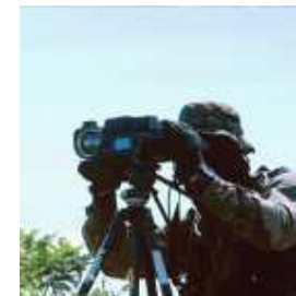
Sophie MF , version portable de la gamme d'équipements de reconnaissance
