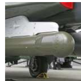
Nacelle de désignation multifonction Damocles.
